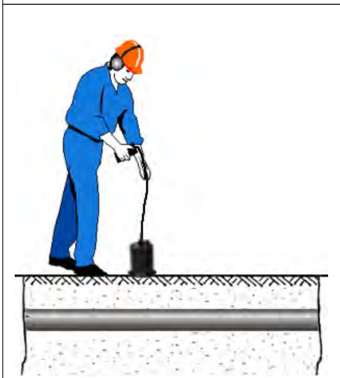
4. Установить акустический датчик над предполагаемой трассой
